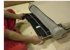
引き出したシートカバーを写真のように、マジックテープが付いてますので貼り付け下さい。
