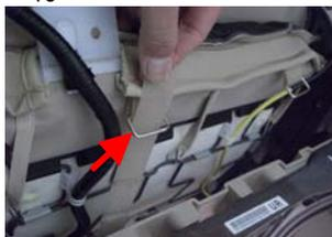
シートの可動部避けて⑭のように左右2箇所固定して下さい。
