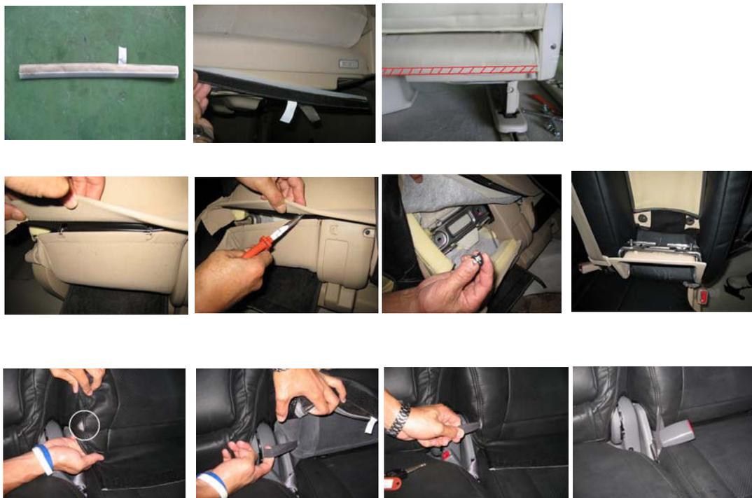
シートカバーを被せていただいた後マジックテープ・紐で可動部分をさけて止めて下さい。
