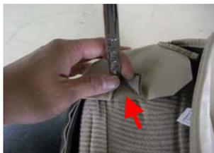
HRの支柱にシートカバーの穴を合せてマジックテープで固定していきます。
