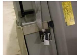
ゴムの紐の先に、黒いフックが付いていますので、純正シートに写真のように固定して下さい。
