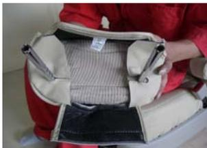
まずヘッドレストの前後を確認し、シートを純正HRのラインに合せながら、被せていきます。
