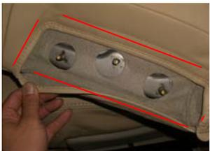
マジックテープで、純正シート部分へ貼り付け固定して下さい。外したカバー等、戻して下さい。
