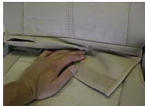
背面と座面との間にシートカバーをラインがズレないように押し込んでいきます。
