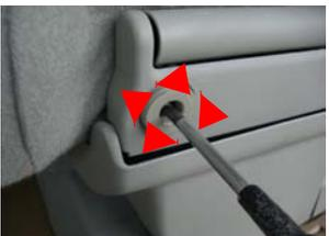
ネジ2ヶ所 12mmのナット3ヶ所プラスチックのカバーが止まっていますので、はずして下さい。
