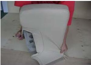
純正シートに合わせて、均等にカバーを被せていきます。矢印のように、紐が取り出せます。
