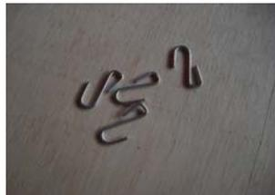
純正シートの形状に合わせて、シートカバーを被せ、左右のS字フックを4ヶ所外して置きます。
