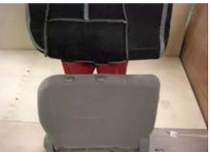
装着するカバーを裏返します。左右均等に、純正シートに被せていきます。
