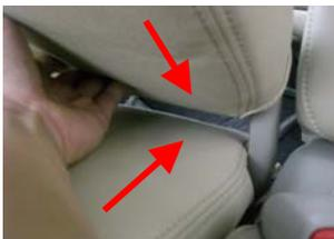
赤ラインの裏面にマジックテープが付いていますので、純正シート部分に固定して下さい。
