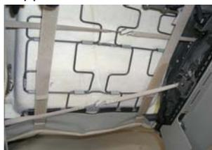
注)絶対に可動部分に干渉しないよう確認してS字フック・紐を固定して下さい。
