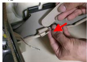
座面の前方よりマジックテープを金具に通して下さい。
