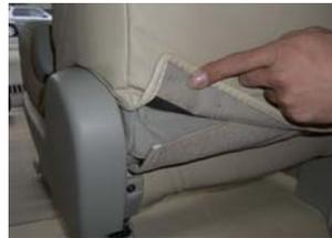
取り出した部分を調整してマジックテープで固定して下さい。
