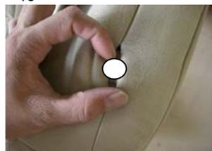
HRの穴位置を合わせ、シワを伸ばして、背面に装着させて下さい。
