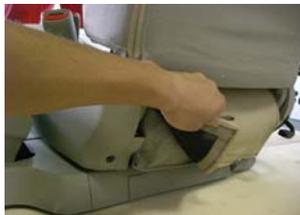
引き出したシートカバーを写真のようにマジックテープで貼り付け下さい。
