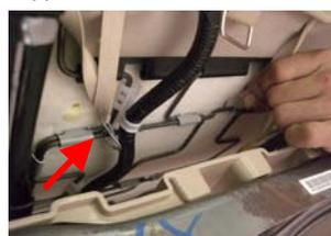
左右に出したS字フックを写真のように金具に掛けて、座面が動かないように固定します。
