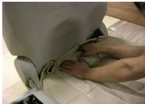
背面と座面との間にシートカバーをラインがズレないように押し込んでいきます。
