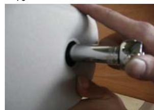
写真のように、ラチェットで外して下さい。
