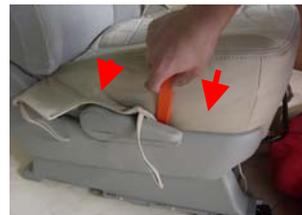
写真のようにトリム(座面のプラスチック部分)と座面の隙間にカバーを押し込んで下さい。
