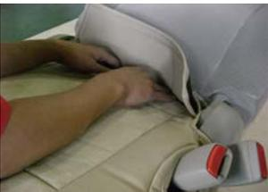
ラインを合せて弛みシワを伸ばして整え、背面と座面との間にシートカバーを押し込んでいきます。
