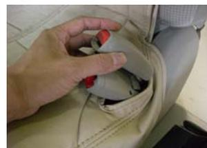
シートベルトのバックル(差込口)をシートカバー穴の空いている部分に通して下さい。
