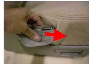
シートベルトを差し入れる袋状の部分がありますので、シートベルトを折り畳み収納して下さい。
