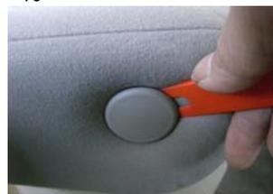
プラスチックのカバーはピンで固定されているだけです。内張りをはがし等で外して下さい。
