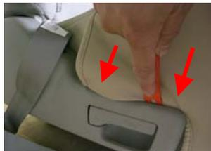
左右のプラスチックの部分にも写真のように、工具を使って押し込んでいきます。
