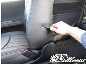
5、背もたれカバーを被せ、カバーに穴を開けます。予めマジック等で穴を開ける箇所に印をつけ、カッター・ハサミ等で穴を開けます。
