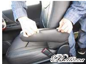
10、画像のように指でつまみ、カバー内部の縫いしろ(画像9参照)を均一方向に整えます。
