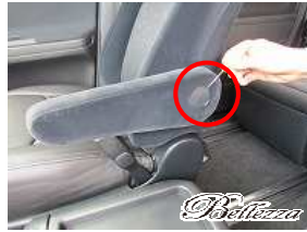
2、マイナスドライバーや内張りはがしを使用し手前に押し上げカバーを外します。
