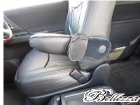
7、背もたれにアームレスト本体を取り付け、カバーを被せます。
