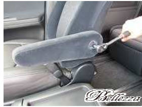
3、ボックスレンチを使用して、ボルトを外します。
